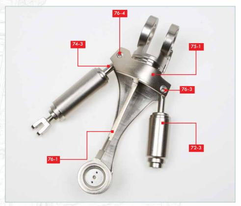
Vérifiez que les vis **76-4** et **76-3** traversent bien respectivement les pièces **75-1**, **74-3** et **76-1** d'un côté, et **75-1**, **72-3** et **76-1** de l'autre, et serrez-les pour fixer l'ensemble.
