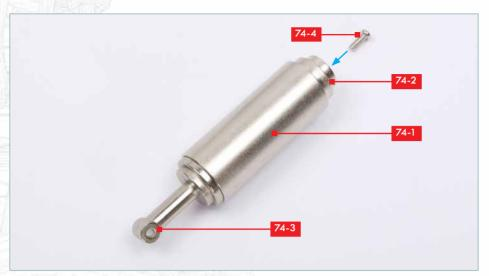
Insérez une vis PM **74-4** dans le trou de la tige 3 **74-2** insérée dans la pièce **74-1**, de façon à pouvoir la visser dans la douille du capuchon **74-3**. Fixez les pièces ensemble en serrant la vis.
