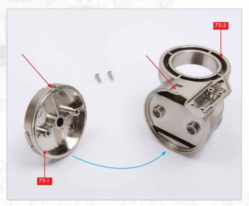
Prenez la pièce de l'épaule **73-1** et l'articulation de l'épaule **73-2**. Notez que ces deux pièces ont des encoches sur le bord (flèches rouges). Celles-ci doivent s'adapter l'une à l'autre. Assemblez les deux pièces comme indiqué par la flèche bleue, en faisant correspondre les encoches.
