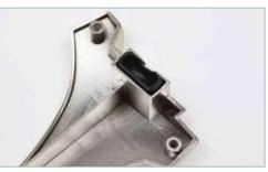
Prenez la garniture 2**76-2** et insérez-la dans le logement de l'extérieur du bras gauche **76-1** à l'aide d'une pince brucelles. Notez que les découpes sur les bords du logement de l'extérieur du bras gauche et de la garniture doivent s'aligner (voir petite photo ci-dessus).
