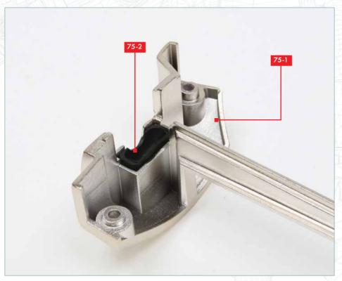
Assurez-vous que la garniture 1 **75-2** est insérée à fond, de façon que les bords des pièces **75-1** et **75-2** soient au même niveau.
