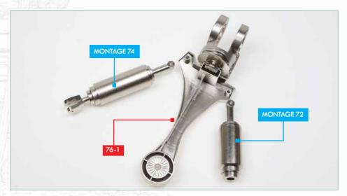
Prenez les assemblages réalisés avec les guides de montage 72 et 74. Positionnez-les à gauche et à droite de l'extérieur du bras gauche **76-1**, comme montré sur la photo. Notez que l'assemblage du guide de montage 74 est le plus grand.
