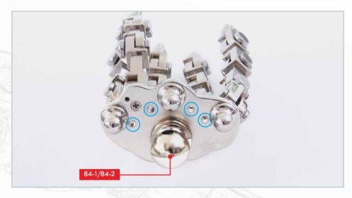
Prenez l'assemblage de la main avancé à l'étape 7 et vérifiez que la rotule **84-1/84-2** est bien fixée. Repérez les quatre trous à la base de la main indiqués par des cercles bleus. Les ressorts musculaires de l'avant-bras **80-4** vont passer dans ces trous.
