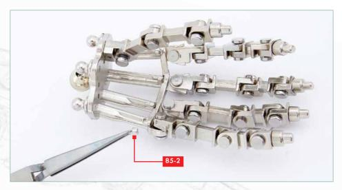
Insérez le connecteur **85-2** encollé dans l'un des trous rectangulaires de la main. Répétez les étapes 6 et 7 pour fixer les trois autres connecteurs **85-2**.
