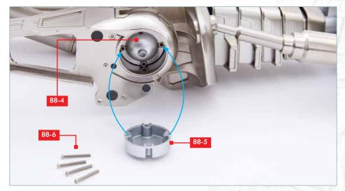
Prenez le couvercle extérieur de l'articulation de la hanche **88-5** et positionnez-le pour faire correspondre ses deux sections légèrement surélevées sur les côtés aux trous de vis à l'intérieur de l'articulation de la hanche (flèches bleues). Préparez quatre vis PM **88-6** avant de passer à l'étape suivante.
