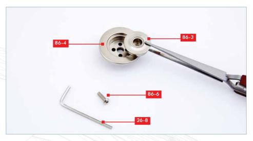
Avec une pince, retournez la fixation de l'articulation **86-4** et placez le couvercle de l'articulation **86-3** dans le logement prévu à cet effet. Préparez une vis à six pans PM **86-6** et la clé Allen **26-8**.
